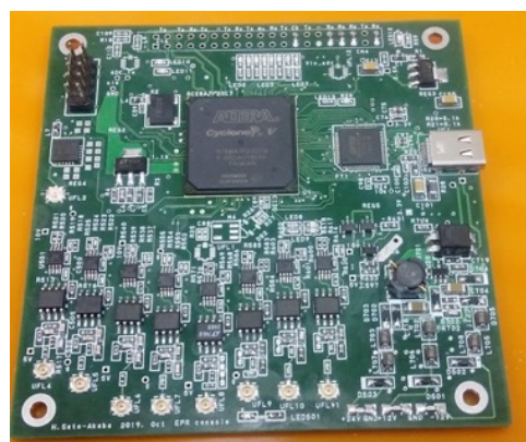
図 3 EPR コンソール用 FPGA 制御ボード
