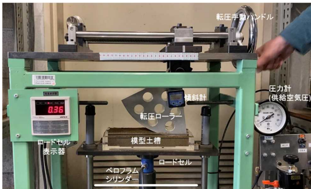
写真-1 転圧模型試験機
