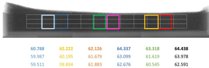
図-7 転圧後の模型土槽 CT 画像及び各解析領域の平均 CT 値
