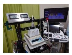
加えた力とディジタルパネルの表示はリニアの関係になり、圧力センサのプロトタイプの開発に成功した。
