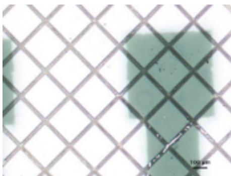
左：図6 金蒸着を行った直後のパリレンフィルム (格子状のパターン以外にも金が付着している。)
