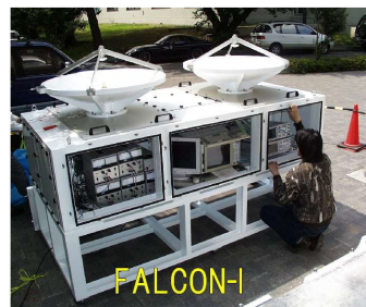
図1. 高感度 95 GHz ミリ波雲レーダ FALCON-I の外観
