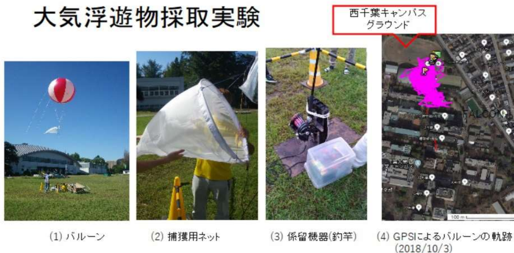
図 5. 大気浮遊物を採取するために、係留気球(写真 1)に捕虫用ネット(2)を着けて、高度約 300m に係留し、日中の約 12 時間の間、3 時間ごとに下して、捕虫した大気浮遊物を回収した。
