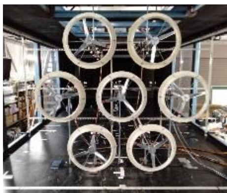
図 1 マルチレンズ風車の風洞実験
