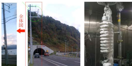
図7. 羅臼の観測装置地点(左)と低温室でのがいし着雪実験(右)
