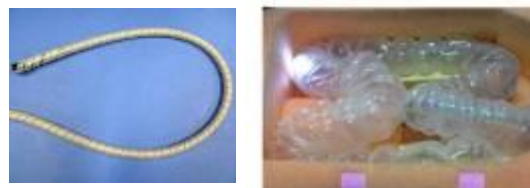
図10 内視鏡への搭載と大腸ファントムへの挿入実験
