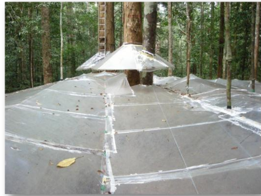
写真1. 降水遮断装置 (横から)
