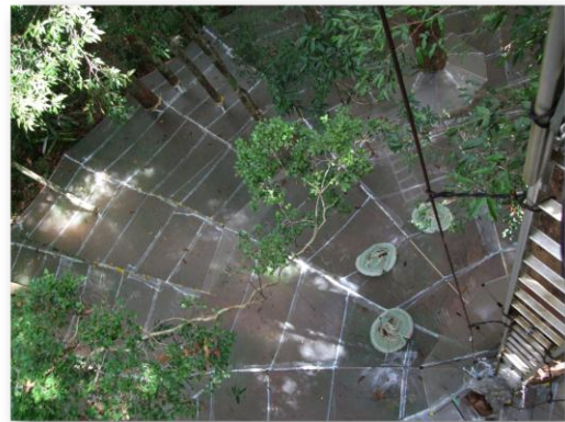
写真2. 降水遮断装置 (上部から)
