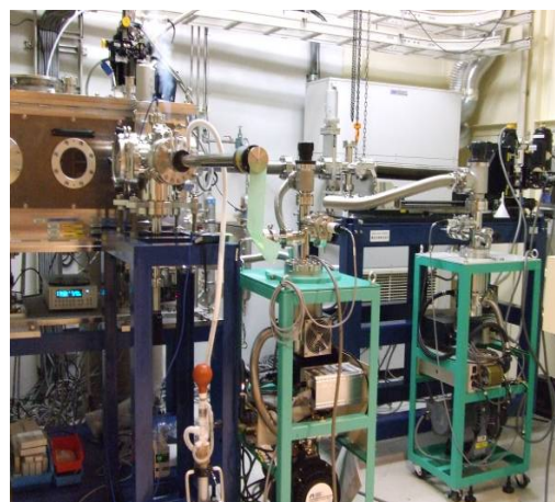
図5 凍結水和生体試料観測のためのクライオスタットおよびクライオトランスファー装置。SPring-8 BL29XUの第1ハッチに設置された様子を示す。
