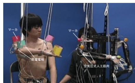
図3 筋骨格ロボットのマスタースレーブ制御
