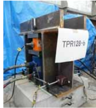
写真4 実験中のテーパー鋼板ジベル供試体
