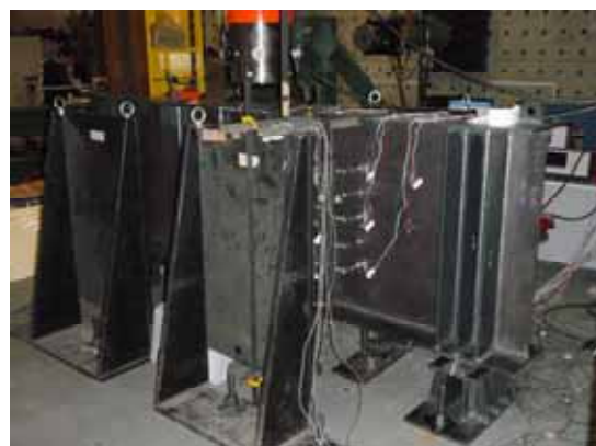
写真 2 実験前のせん断載荷用供試体
