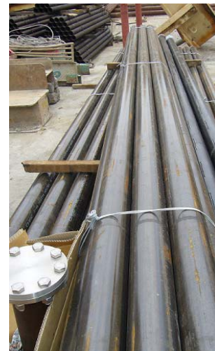
図 2. ケーシングに使用された鉄管。
