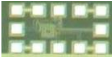
図2：試作したイコライザ回路
