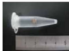
図 ゲル内に封入した試作共振器の例
