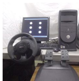
図 1 簡易 DS (画面は反応時間測定画面)
