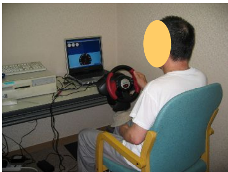
図3 簡易 DS を使用する協力者 (アクセル・ブレーキ操作の検査中)
