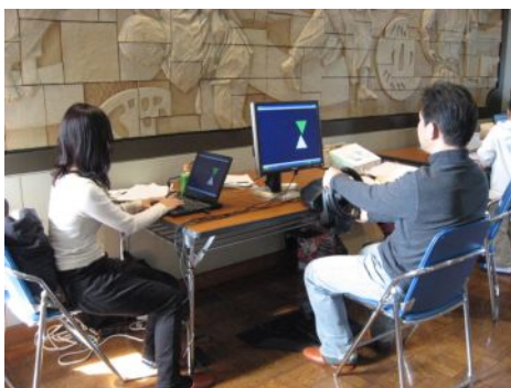
図2 簡易 DS を操作する協力者 (ハンドル操作の検査中)
