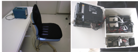
図5 椅子に着脱可能な連動型CPMと内部機構
