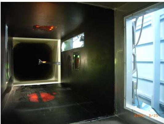
図：クロスボウ模型の磁力支持
