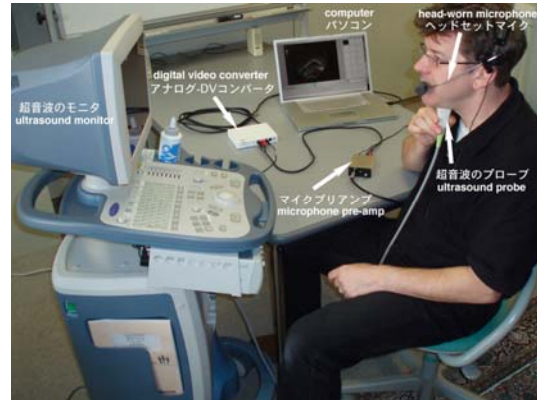
図1. 発声中の舌の動きの超音波映像を作るための設備
