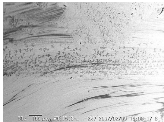
図7 6203 内輪軌道面観察写真(走査電子顕微鏡写真)
