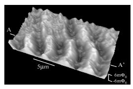
図8 ハードディスクの磁気像
