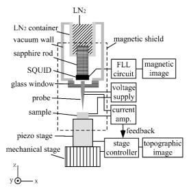
図 7 STM を併用した SQUID 顕微鏡
