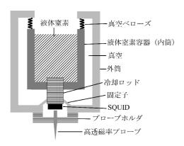
図2 本研究で提案した磁場分解能改善 を目的としたSQUIDプローブ磁気 顕微鏡ヘッド
