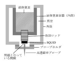
図 1 SQUID プローブ磁気顕微鏡ヘッド
