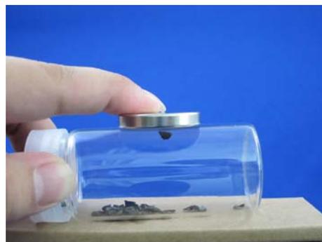
図3 ガラス容器に回収したポリアクリロニトリル(PAN)を熱分解した試料が永久磁石に吸引されている写真
