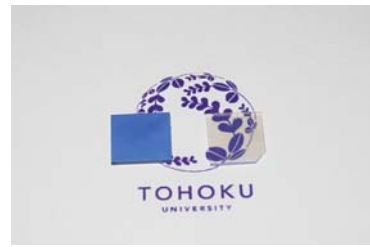
図4 Bi含有酸化チタン結晶化ガラス(左)とBiフリー酸化チタン結晶化ガラス(右)の写真
