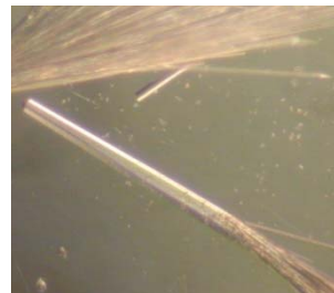
図 5 : RsbX の結晶 (太さ 50 ミクロン程度)
