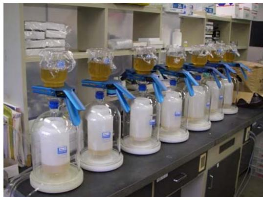
写真1 孔径 $0.025\ \mu\text{m}$ 、直径90 mmのメンブレンフィルターを用いた吸引濾過システム(7台)による水試料(中粗粒灰色台地土、長久手、野菜畑、豚糞堆肥区)の吸引濾過の様子。濾液は、容量2 Lのポリ瓶によって受ける。
