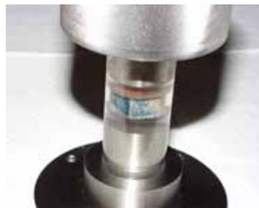
図は上から、(A)構造解析および強度解析のために切り出したサンプル(B)マイクロCT撮像(C)圧縮強度試験の状況を示す。
