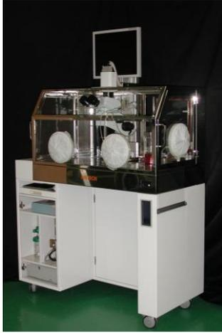
本装置は、1. 循環濾過によりほぼ無塵(チャンバー内ガスは150回濾過/hr)、2. 感染防止フィルムの使用、3. 追跡性の保証、4. チャンバ所的に無酸素、2.0% O<sub>2</sub>濃度環境、などの特徴を有する。
