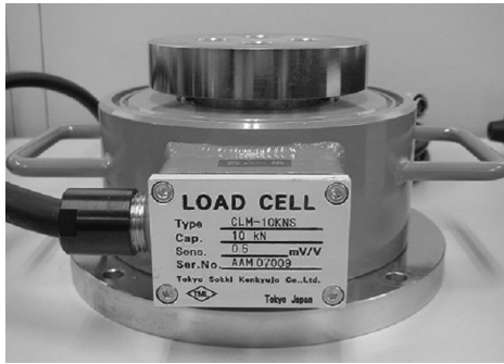
図1 衝撃力測定用ロードセルの外観
