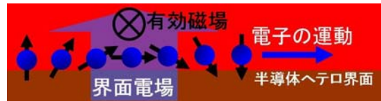
図2：半導体ヘテロ界面でのスピン軌道相互作用 [半導体ヘテロ界面上を運動する2次元電子は、相対論的效果により“界面電場”及び電子の運動方向双方に垂直な方向に有効磁場を感じ、それによりスピンの回転する。]
