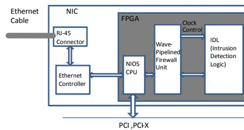
H-HIPS (Hardware-based HIPS) の特徴である FPGA (Field Programmable Gate Array) の特徴を生かし、アノマリ検知方式による DDoS (Distributed Denial of Service) 攻撃防御ユニットの開発を行った。DDoS 攻撃への対処方法はこれまで限られているが、本研究の成果によって多様な DDoS 攻撃からコンピュータシステムの防御が可能になる。下図は、本研究で開発した DDoS 攻撃防御ユニットのアルゴリズムである。このアルゴリズムを低消費電力型の FPGA を使用してプログラムした結果、2.6Gbps 動作することが確認された。
