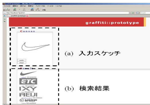
図2 試作した類似商標図形検索システム
