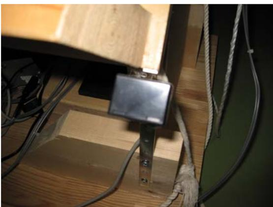
写真 3. 不定期神経伝導速度測定装置用トリガーパルス出力装置
