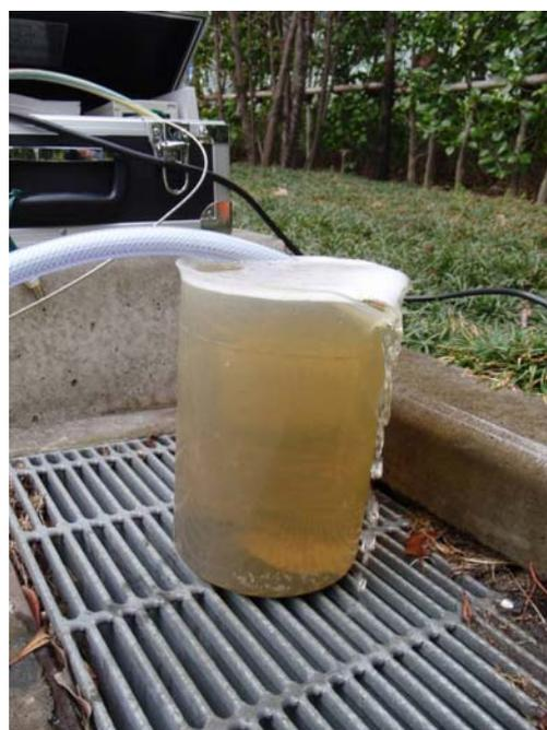
図4 江戸川層下部の砂礫層中より揚水された有色地下水の様子。溶存ガスが脱ガスし、水面で発泡している。
