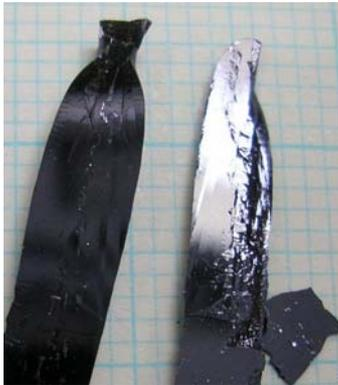
図 1.  $\text{La}_{0.5}\text{Sr}_{1.5}\text{MnO}_4$  の単結晶試料(へき開面)
