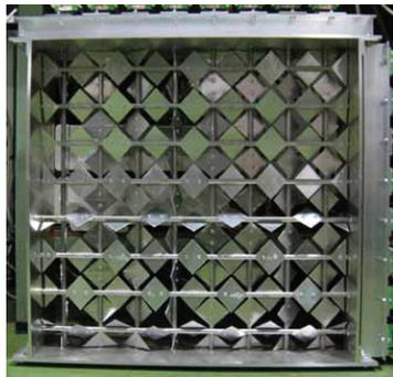
図 1 動的乱流発生装置
