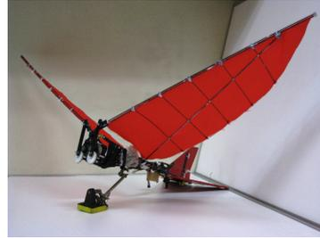
図6：羽ばたき飛行ロボット
