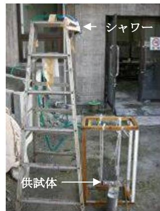
図3 人工降雨装置
