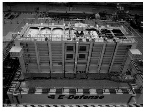
写真 1 調査を実施した直方体土槽内の大型模型地盤
