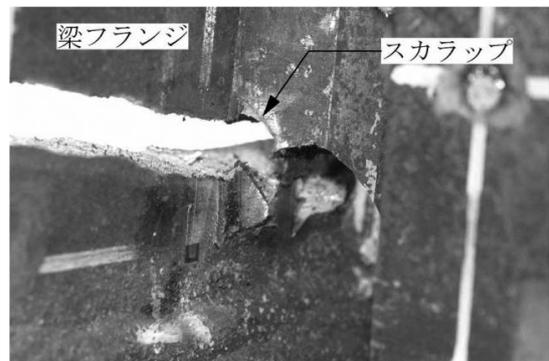
写真3 梁フランジの脆性破断（内面）
