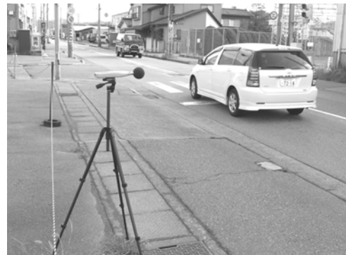
図 2 道路交通騒音の測定風景
