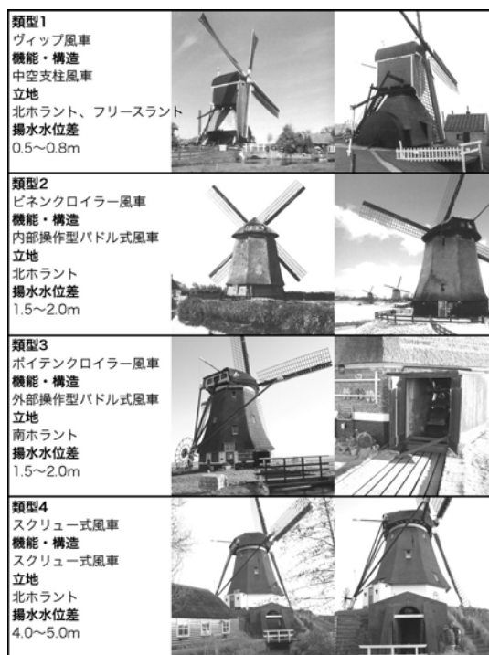
図5 ポルダー風車の4類型
