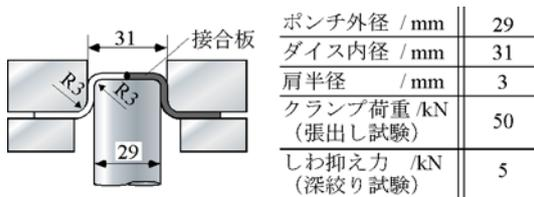
Fig.15 平頭張出しおよび深絞り試験方法
