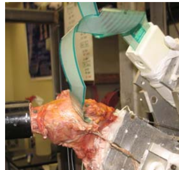
感圧センサーの設置
