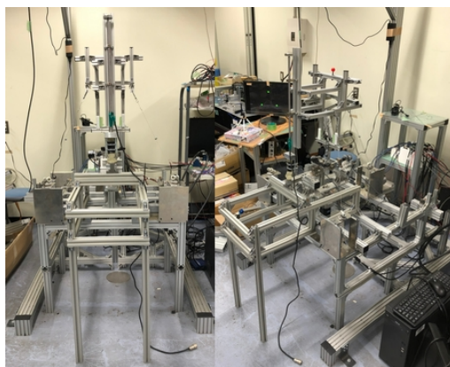
写真1 平行ワイヤ駆動機構による母指CM関節負荷試験装置
