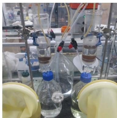
図 2 樹脂に NaI 溶液を通して純化している様子。
