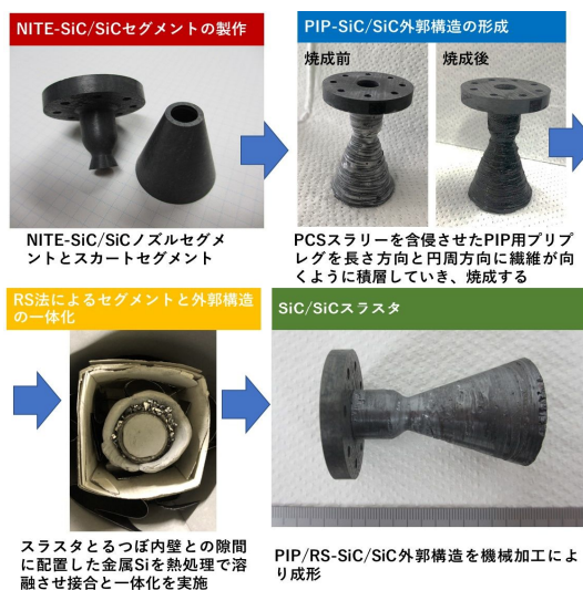
図 8 SiC/SiC スラスタの作製プロセス
