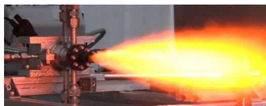
図 10 水冷燃焼器を用いた燃焼試験
