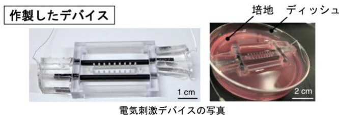
図3 ファイバ心筋組織用の電気刺激培養チャンバ
