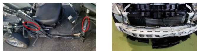
図2 衝突実験後の変形部位例
