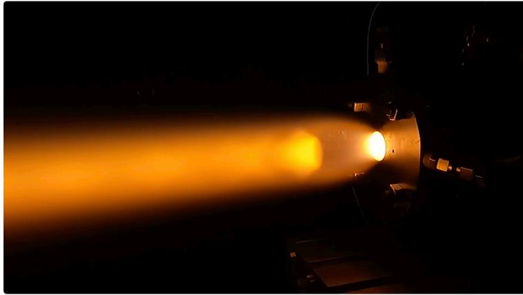
図5 作動中 RDE の典型的な排気ブルーム ( $\text{H}_2/\text{O}_2$ , 当量比 1.0, 総流量 30 g/s)
