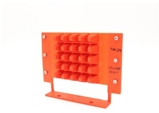
図7 製作したリッジフィルタの写真。
